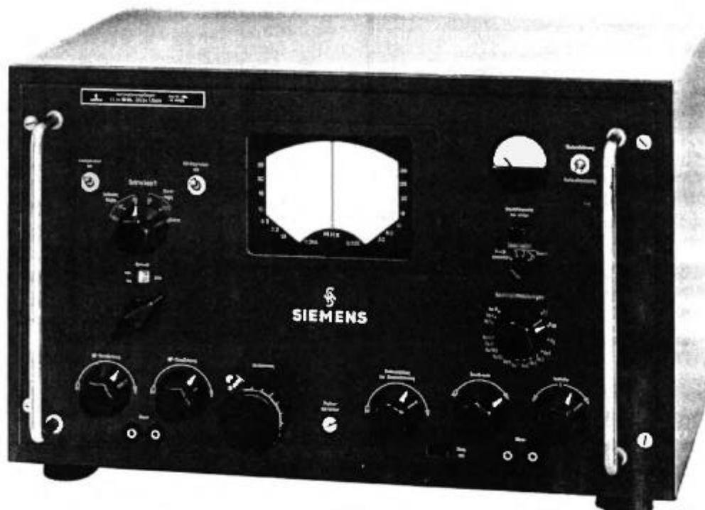
Bild 1 Kurzwellen-Empfänger Funk 745 E 309
